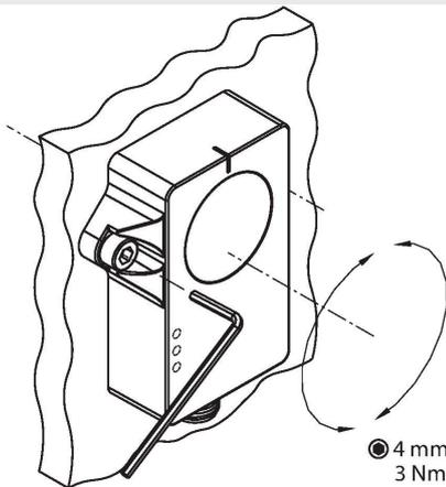
Das Messprinzip ermöglicht eine einfache Montage und Inbetriebnahme, da sich zum Beispiel in einer Metallumgebung nicht störend auf das Messprinzip auswirkt.
