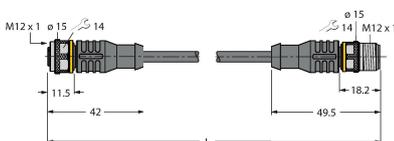
Verbindungsleitung, M12-Kupplung, gerade, 4-polig auf M12-Stecker, gerade, 4-polig; Leitungslänge: 2 m, Mantelmaterial: PUR, schwarz; cULus-Zulassung
