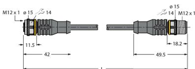
Adapterleitung (unter anderem zum Anschluss des Sensors an die Parametereinheit USB-2-IOL-0002); M12-Kupplung, gerade, 5-polig auf M12-Stecker, gerade, 3-polig; Leitungslänge: 1,5 m; Mantelmaterial: PUR, schwarz; cULus zugelassen; RoHS-konform; Schutzart IP67
