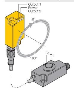
programación de los puntos de conmutación mediante el adaptador de teach TX1-Q20L60 Cuando se acciona el conmutador T1 (SALIDA 1), se forma un puente entre la conexión a tierra y la patilla 5. Cuando se acciona el conmutador T2 (SALIDA 2), se forma un puente entre el UB y la patilla 5.
