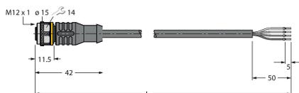
Cable de conexión, conector hembra M12, recto, de 4 polos, longitud del cable: 2 m; material de revestimiento: PVC, negro; aprobación cULus
