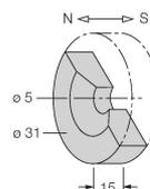
Aimant de commande, Ø 31 mm (Ø 5 mm), h : 15 mm ; distance de commutation atteignable de 90 mm pour les détecteurs de champs magnétiques BIM-(E)M12 ou 78 mm pour les détecteurs BIM-EG08 ; en cas d'utilisation avec des détecteurs de positionnement linéaire Q25L : distance recommandée entre le détecteur et l'aimant : 3...5 mm
