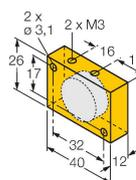
Aimant de commande ; rectangulaire et en plastique ; distance de commutation atteignable de 58 mm pour les détecteurs de champs magnétiques BIM-(E)M12 ou 49 mm pour les détecteurs BIM-EG08 ; en cas d'utilisation avec des détecteurs de positionnement linéaire Q25L : distance recommandée entre le détecteur et l'aimant : 3...5 mm
