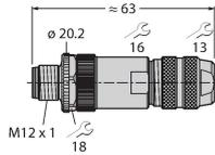
Connecteur male confectionnable, M12 x 1, droit, 8 pôles, raccordement par borne à vis, diamètre de ligne 6.0 à 8.0 mm, section conducteur/section raccordable 0,14 à 0.50 mm<sup>2</sup>, boîtier métallique, écrou de montage métallique, peut être blindé, e.a. pour Ethernet
