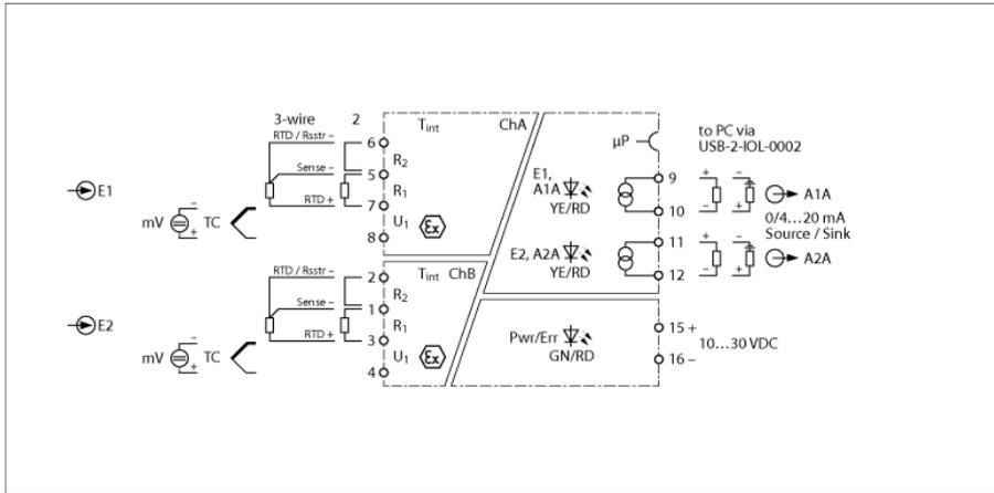
L'amplificateur de mesure de température à 2 canaux IMX12-TI02-2TCURTDR-2I-C0/24VDC dispose d'entrées pour: des thermocouples suivant CEI 60584, DIN 43710, GOST R 8.585-2001, des tensions faibles (-150...+150 mV), RTD suivant CEI 60751, DIN 43760, GOST 6651-94 (2, 3 fils) ainsi que des résistances 0...5 kΩ (2, 3 fils)
